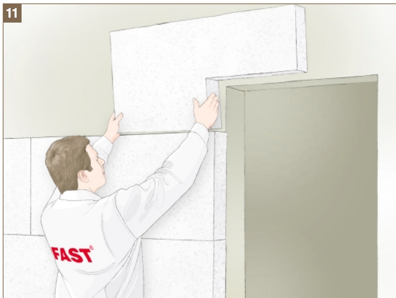
Rys. 11 - Prawidłowy układ płyt termoizolacyjnych przy drzwiach i oknach
